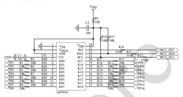
备注: 电源端串接的电阻 R9 可以提高抗干扰能力。
