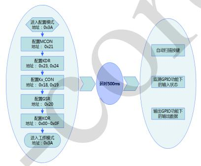
备注:上电后,主控芯片需等待 5ms 之后,才能对 AiP5916 进行初始化操作(建议对写入数据进行 读校验,以确保写入成功)。
